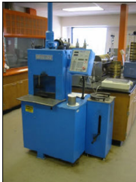
Figura 3.3: Compactador Giratorio SUPERPAVE (SGC)
